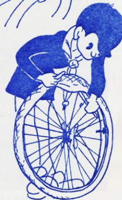
remonter le pneu en tirant sur les démonte-pneus
